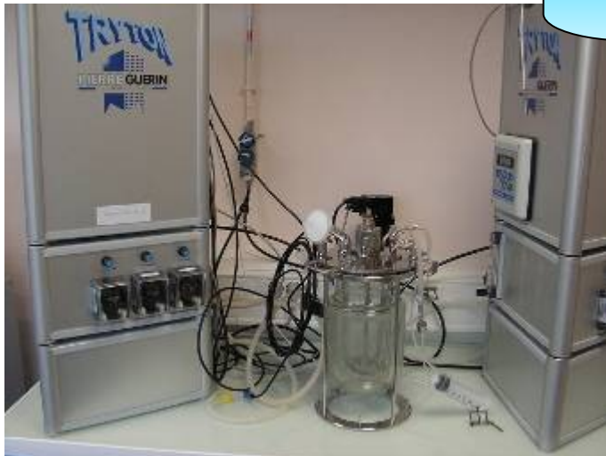
Production en bioréacteur assisté par ordinateur
